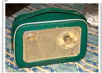
Kabelkový rozhlasový přijímač TESLA 2800B T 58 (výroba 1958- 60)
